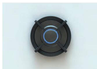
BRUCIATORE PICCOLO Potenza minima 0,3 kW Potenza massima 2 kW Diametro Ø 230 mm Protezione fiamma Accensione automatica a scintilla
