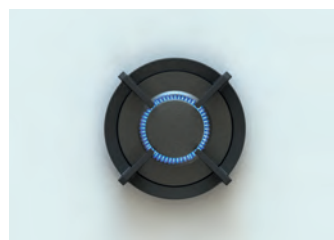
BRUCIATORE MEDIO Potenza minima 0,3 kW Potenza massima 3 kW Diametro Ø 230 mm Protezione fiamma Accensione automatica a scintilla
